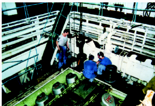
Nahore: Původně bílý náěr stěn a potrubí strojovny postupně dostával špinavě hnědý nádech od unilajících výfukových plynů z hlavního motoru.
